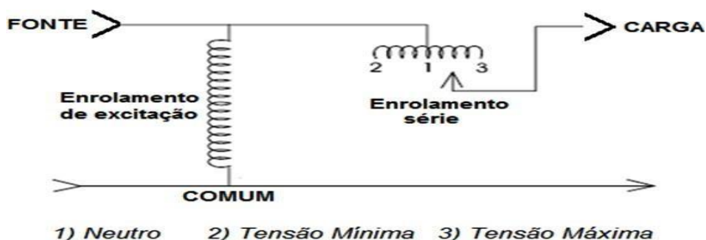
Figura 3 - Autotransformador e enrolamento série com tap's
