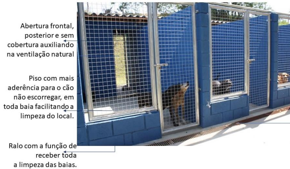
Figura 111 – Canil com ventilação natural correta
