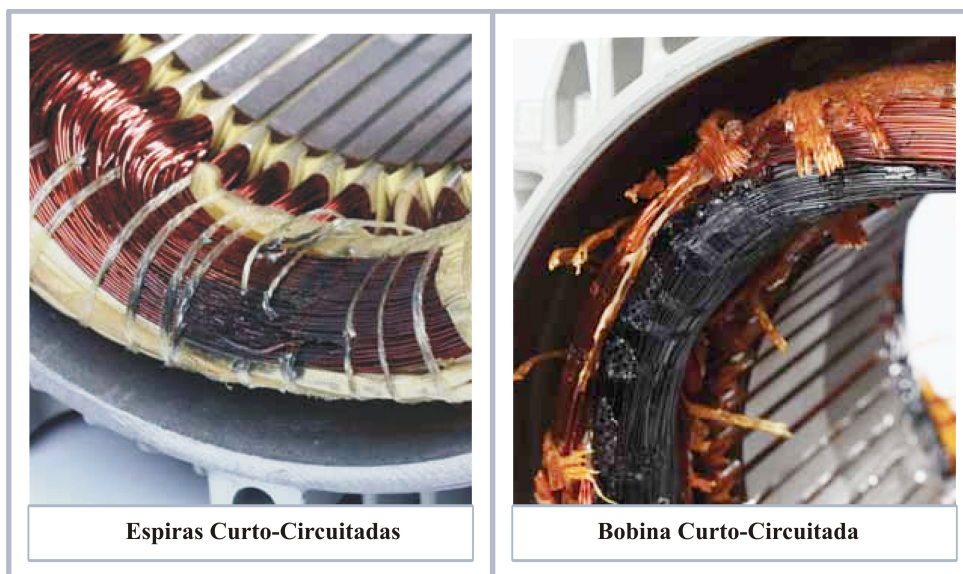
Figura 15 – Motores com avarias originadas por curto-circuitos
