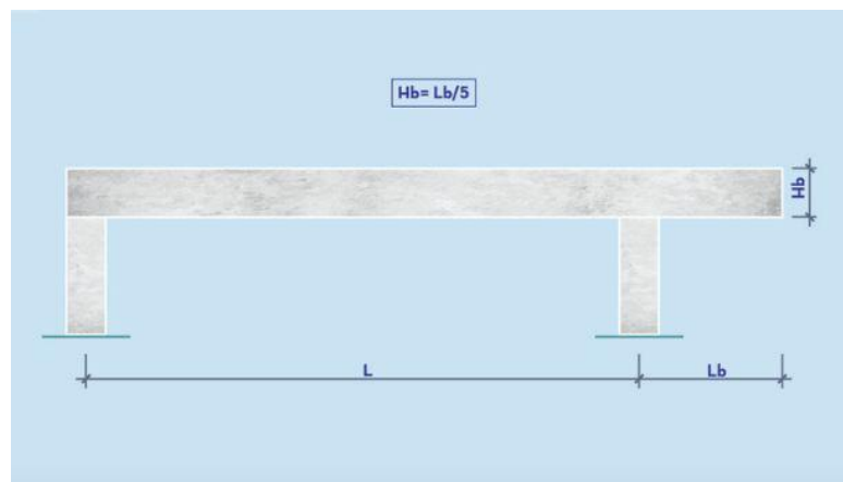
Figura 11: Pré-dimensionamento viga em balanço
