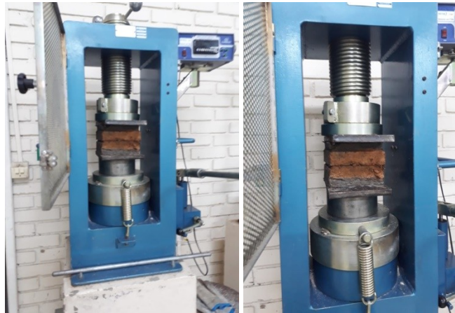
Figura 14 – Ensaio de compressão simples.
