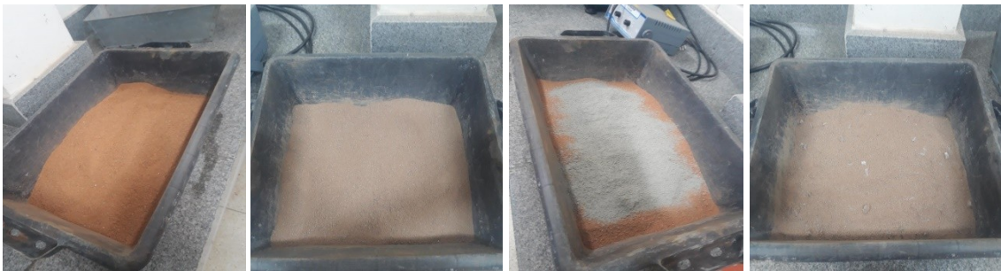
Figura 11 - Homogeneização das Misturas (solo, cimento, fibra).
