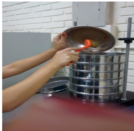
Figura 8- Peneiramento do solo fino.
