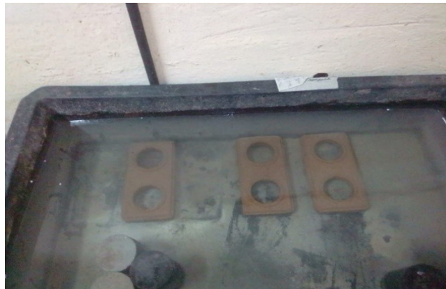
Figura 12 - Tijolos imersos para ensaio de absorção
