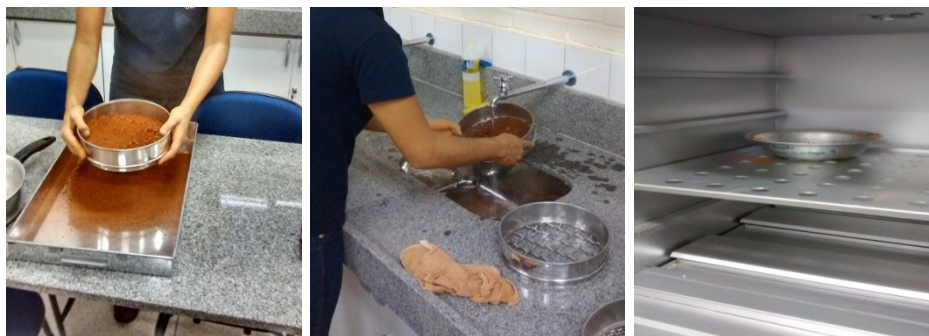
Figura 6- Processo de peneiramento, lavagem e secagem do solo.
