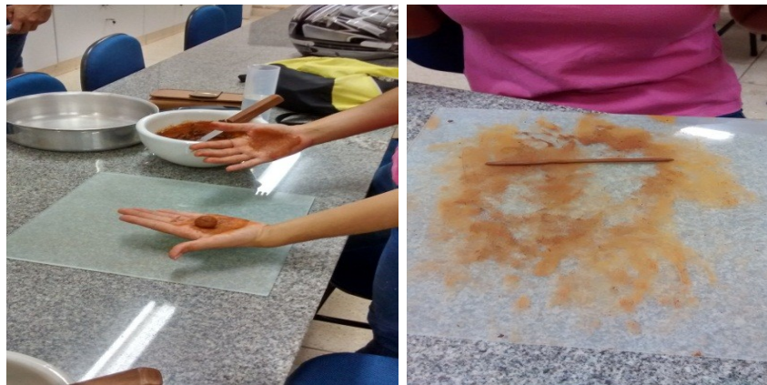
Figura 10 - Moldagem do solo até se formar um cilindro
