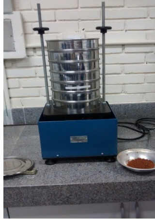
Figura 7- Peneiramento do solo grosso
