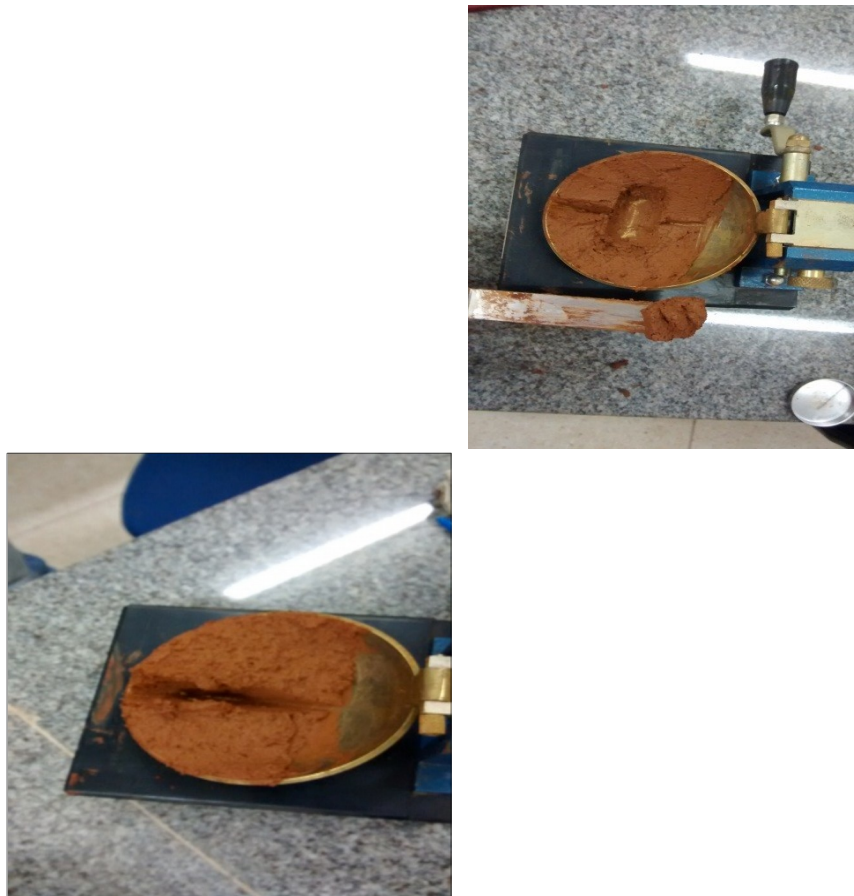
Figura 9 - Ensaio utilizando o Aparelho de Casagrande.
