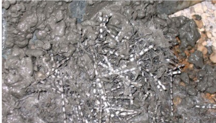
Figura 4– Concreto mais Microfibra
