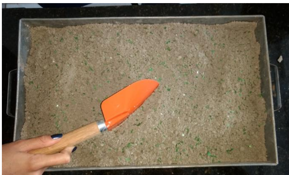
Figura 3.4 Mistura dos materiais pet, papel e cimento Portland.
