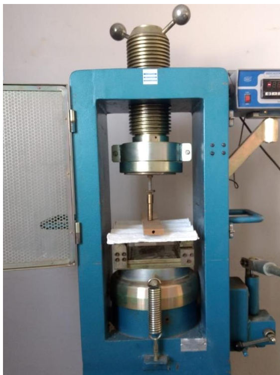
Figura 3.10 Prensa hidráulica utilizada no ensaio de flexão.
