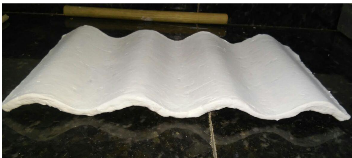
Figura 3.7 Seção transversal do corpo de prova impermeabilizado.
