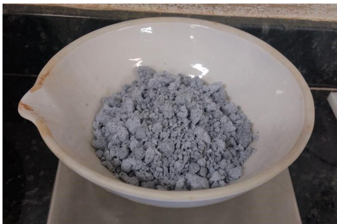
Figura 3.2 Papel apto à reciclagem depois de batido com água.
