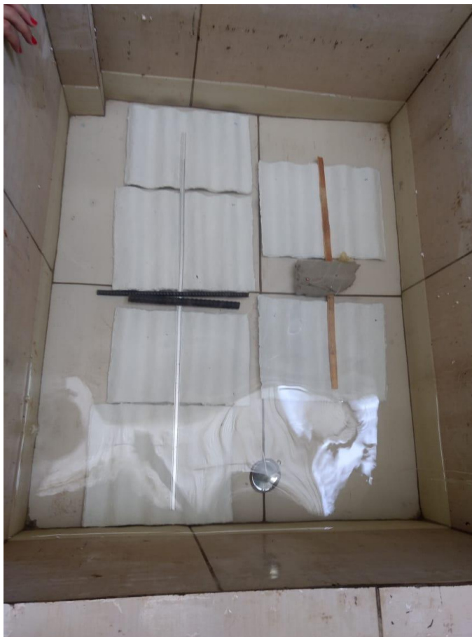
Figura 3.11 Telhas imersas em água para o teste de absorção.
