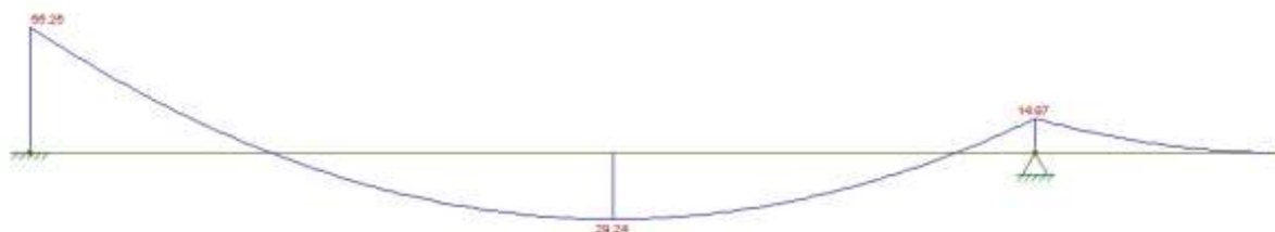
Figura 7. Gráfico de Momento desenhado no ftool
