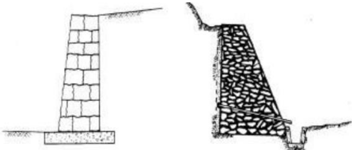
Figura 18: Muros de alvenaria de pedra
