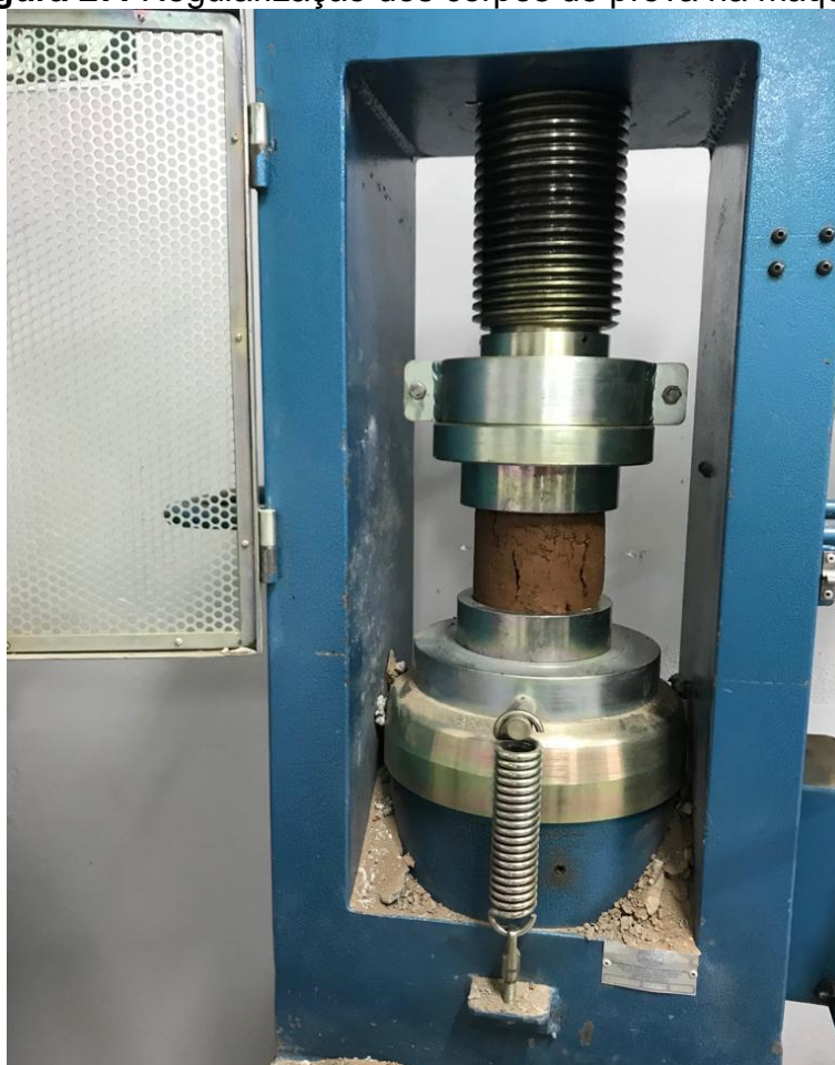
Figura 27: Regularização dos corpos de prova na máquina
