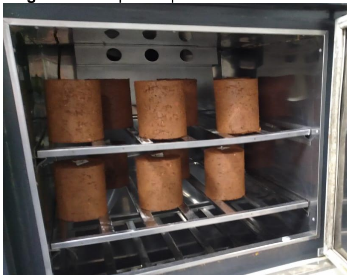
Figura 24: Corpos de prova em câmara úmida
