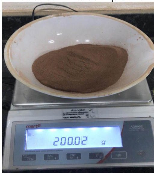
Figura 10: Amostra- Ensaio de Limite de Liquidez e Limite de Plasticidade
