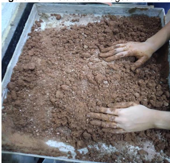
Figura 20: Mistura solo + água + cimento
