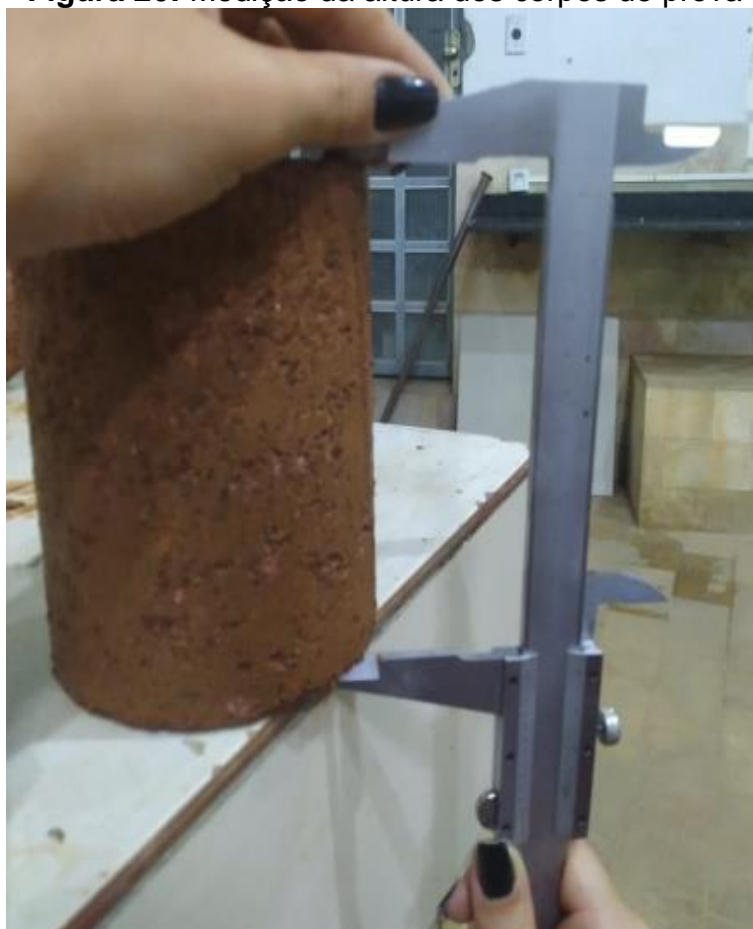
Figura 26: Medição da altura dos corpos de prova
