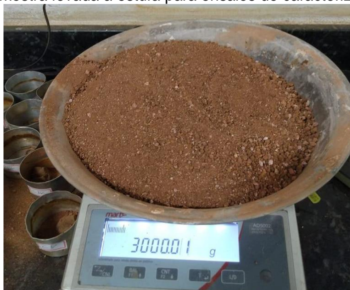
Figura 8: Amostra levada a estufa para ensaios de caracterização do solo
