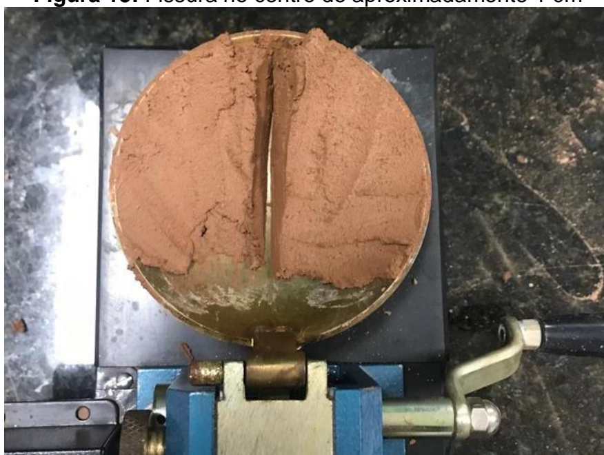
Figura 13: Fissura no centro de aproximadamente 1 cm
