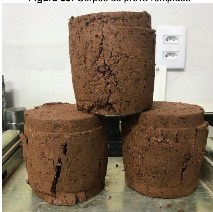
Figura 33: Corpos de prova rompidos
