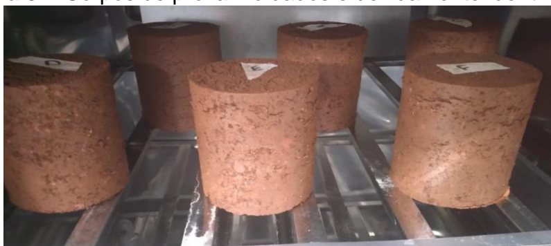
Figura 32: Corpos de prova moldados e devidamente identificados
