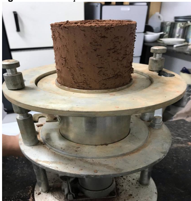
Figura 18: Remoção da mistura com o extrator
