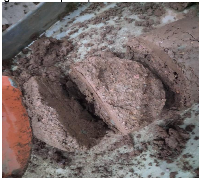
Figura 19: Corpo de prova cortado verticalmente
