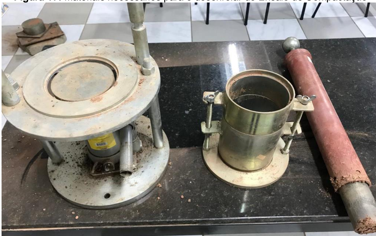
Figura 17: Materiais necessários para o desenrolar do Ensaio de Compactação
