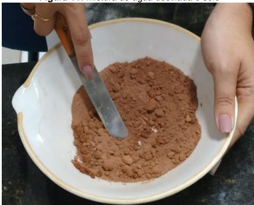
Figura 11: Mistura de água destilada e solo
