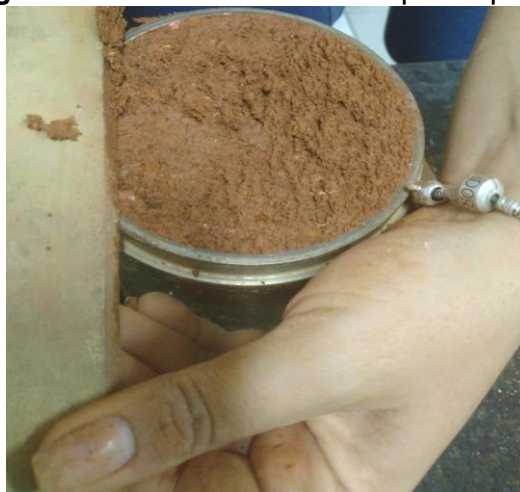
Figura 22: Nivelamento do corpo de prova
