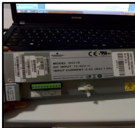
Figura 7: Características da controladora M521B.
