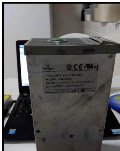
Figura 6: Especificações da unidade retificadora.
