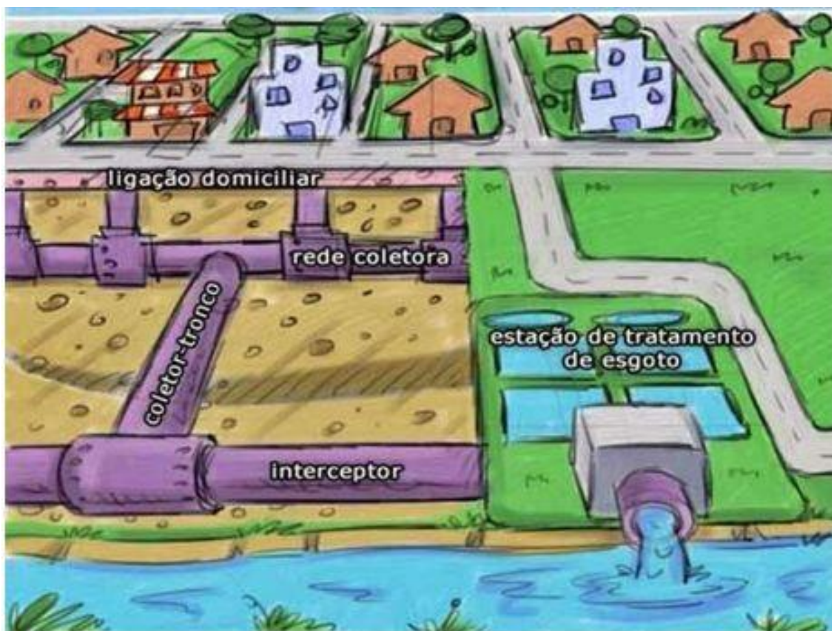
Figura 4 - Rede coletora de esgoto
