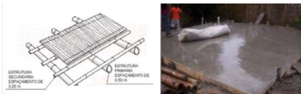
Figura 49 Piso elevado de ripas de bambu e piso com laje
