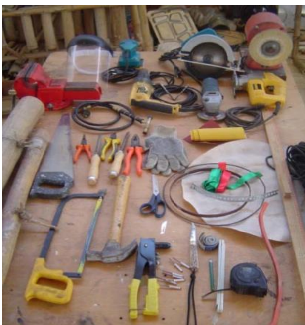
Figura 45 Ferramentas simples para manejo do bambu na construção
