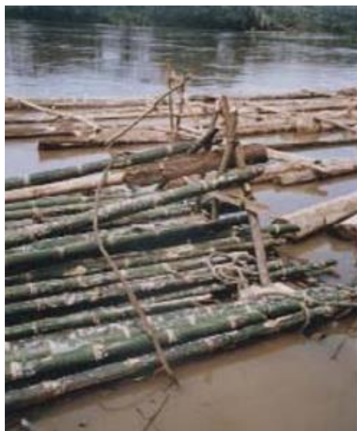
Figura 12 Cura do bambu por imersão em água corrente
