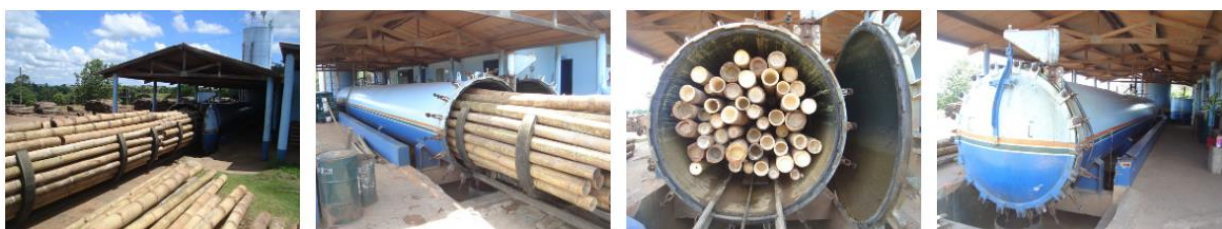
Figura 16 Método de tratamento autoclave
