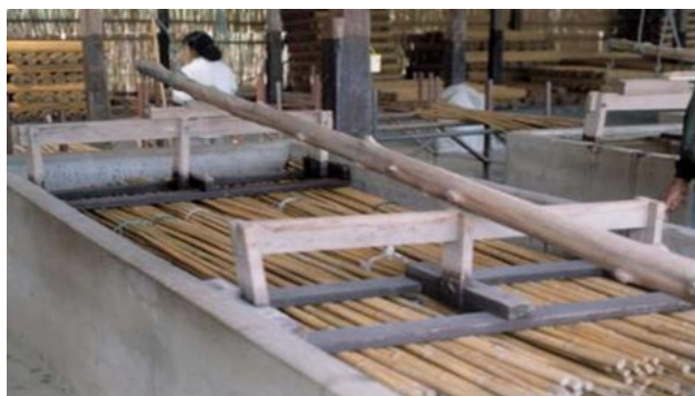
Figura 14 Método de tratamento imersão em solução de sais hidrossolúveis
