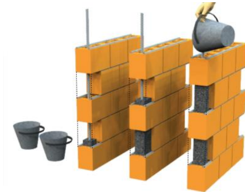
Figura 10 - Lançamento de graute na alvenaria
