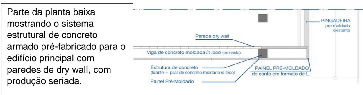
Figura 52: Esquema da estrutura em planta - Centro de Treinamento Luiz Carvalho -
