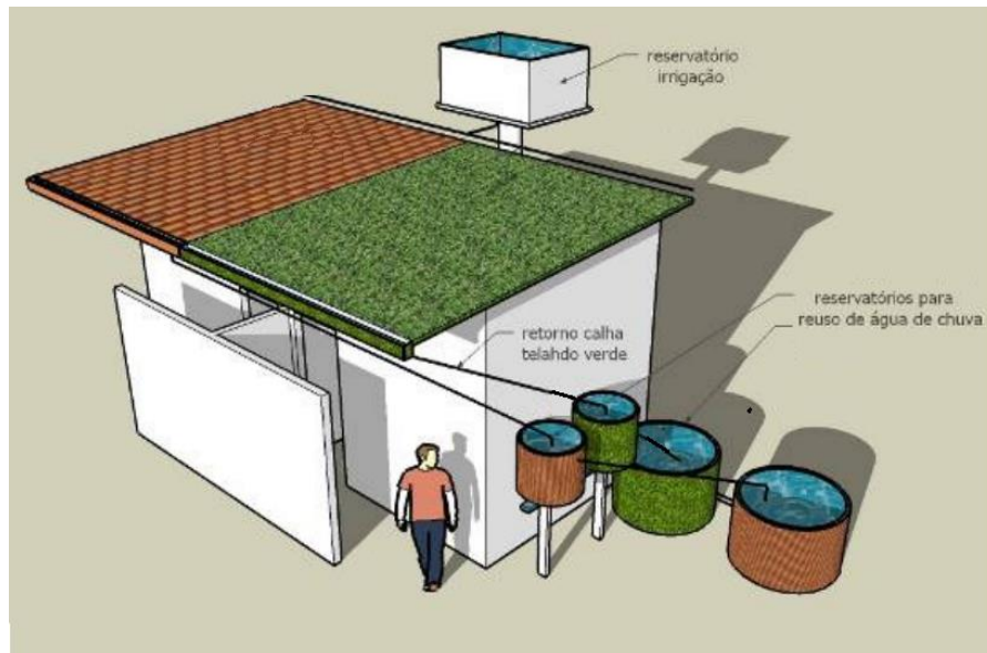
Figura 05: Sistema de telhado verde e reúso d'água.
