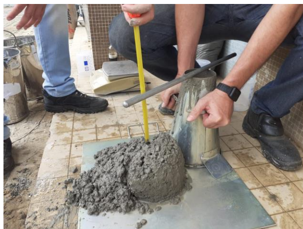
Figura 05: Erros de execução do ensaio no CAPET10
