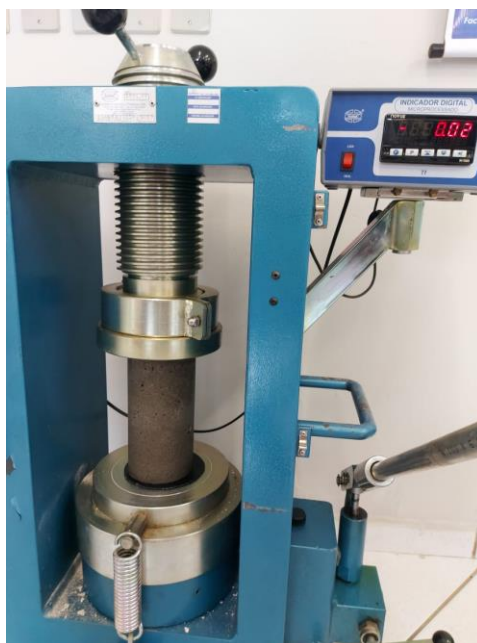
Figura 04: Ruptura dos corpos de prova
