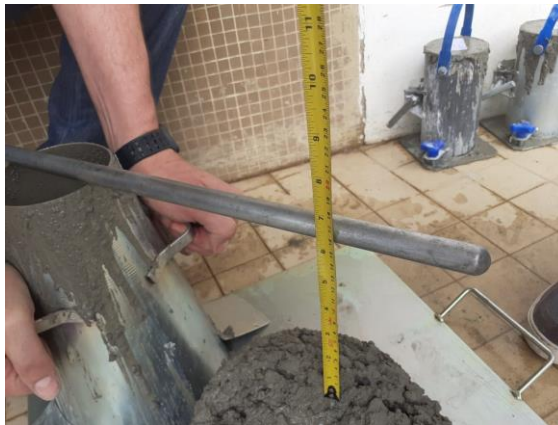
Figura 03: Verificação do abatimento do tronco de cone
