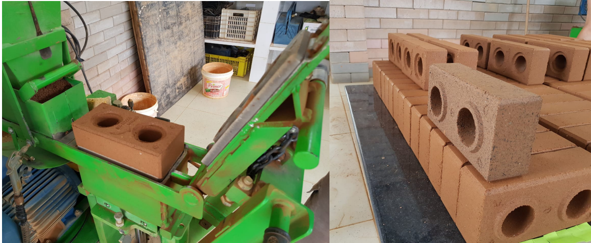
Figura 02: Confeção tijolo solo-cimento Fonte: Arquivos dos autores
