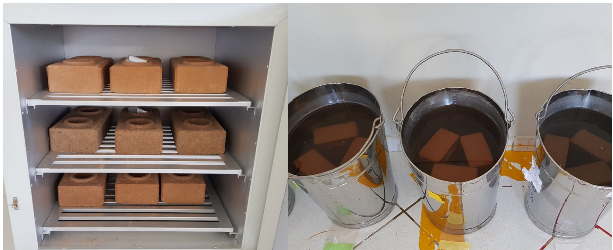
Figura 04: Teste absorção de água Fonte: Arquivos dos autores
