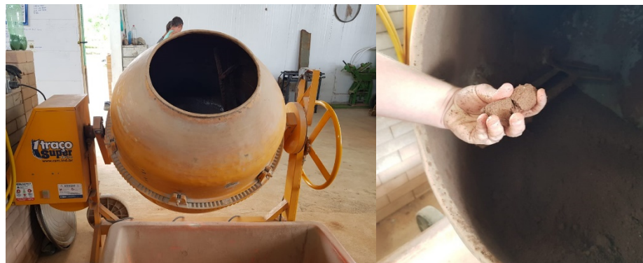
Figura 01: Confecção tijolo solo-cimento Fonte: Arquivos dos autores
