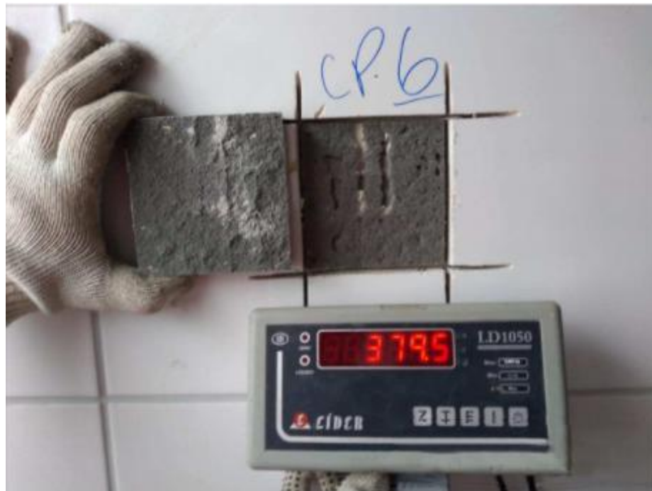
FIGURA 15 - Demonstração Ilustrativa da Obtenção de Dados Quantitativos do Ensaio de Arrancamento
