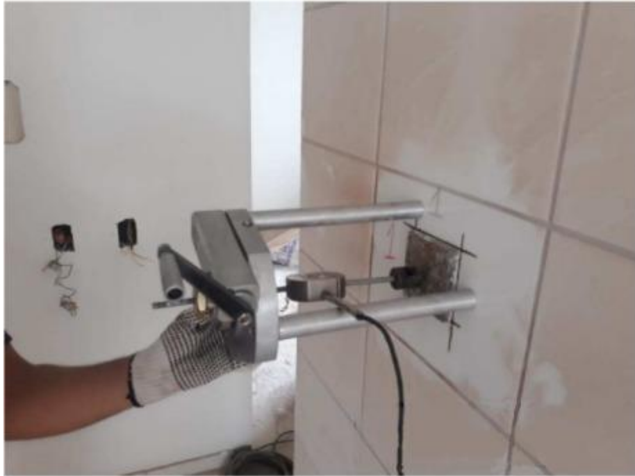
FIGURA 14 - Demonstração Ilustrativa do Ensaio de Arrancamento
