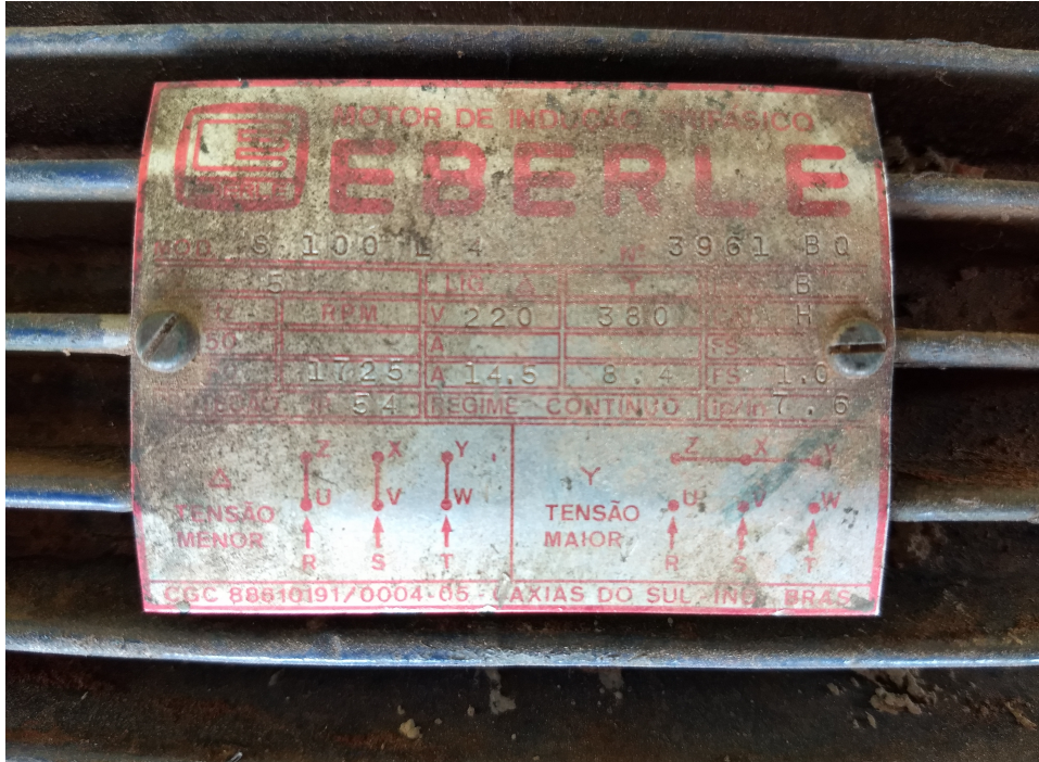
Figura 31: Placa especificações do motor Eberle
