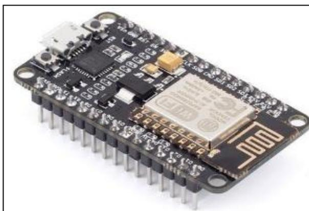
**Imagem 18** – ESP8622 NodeMcu ESP-12E
