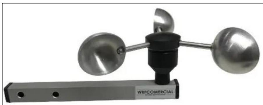
**Imagem 17** – Anemômetro Digital Mini AN1M
