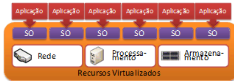
Figura 11 - Modelo virtualizado de processamento
