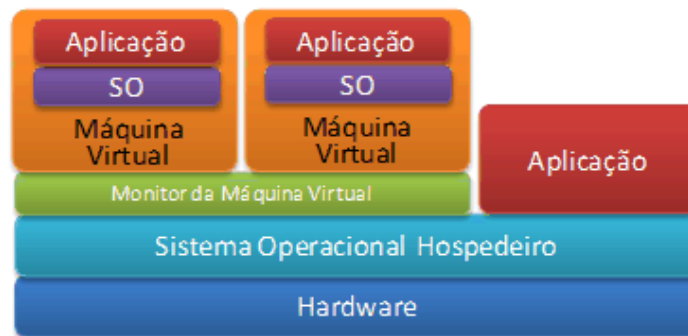
Figura 14 - Arquitetura onde o hypervisor é parte do sistema operacional
