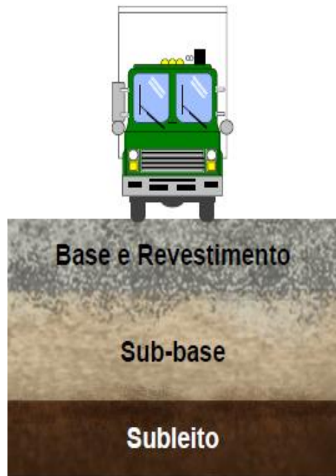
FIGURA 6 – Esquema da seção transversal do pavimento rígido
