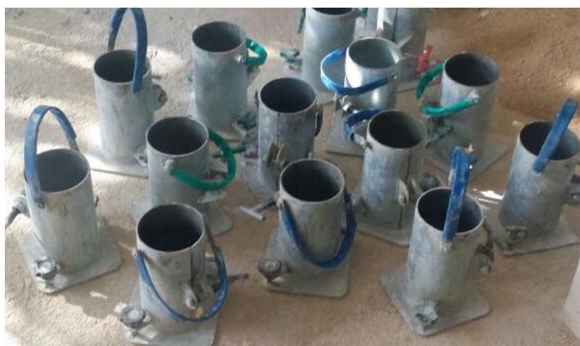
Figura 11 - Moldes de corpos de prova
