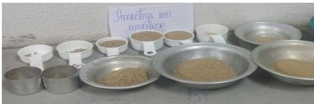
Figura 6 - Areia natural para ensaio granulométrico
