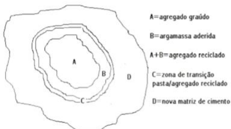
Figura 5 - Microestrutura do concreto reciclado
