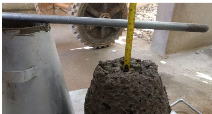
Figura 10 - Abatimento do tronco de cone
