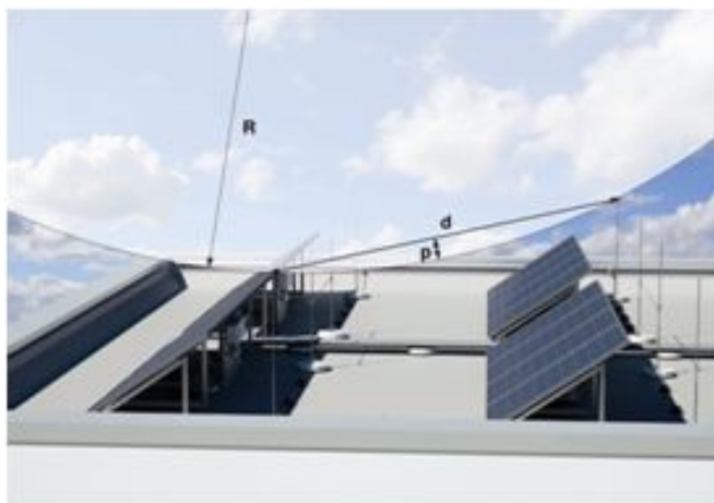
Figura 19: Painéis fotovoltaico dentro da zona de proteção de um SPDA.
