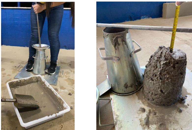
**FIGURA 07 E 08:** ensaio de abatimento do tronco do cone, Slump-Teste.
