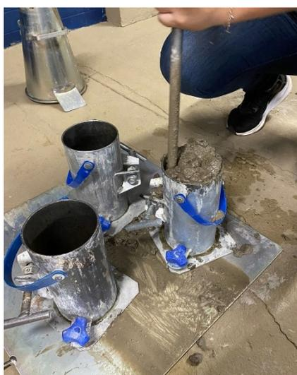
**FIGURA 09:** Adensamento das camadas de concreto nos corpos de prova.
