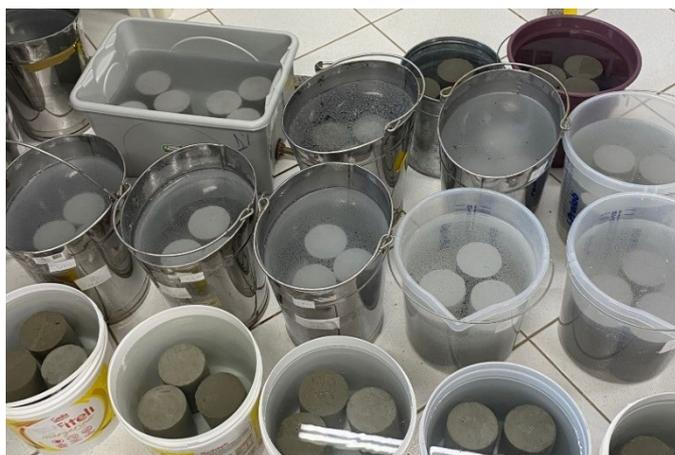
**FIGURA 10:** Cura dos corpos de prova.
