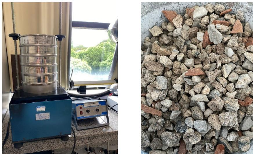
**FIGURA 03 E 04:** Peneiramento e triagem dos RCD.
