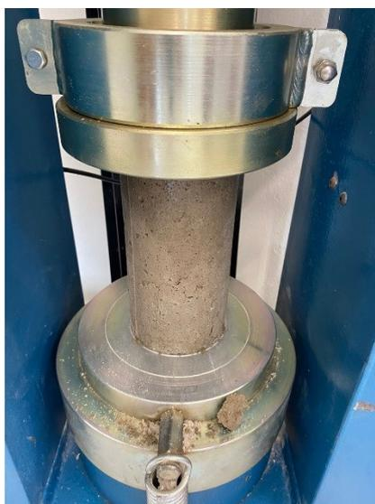
**FIGURA 12:** Ensaio de resistência à compressão.
