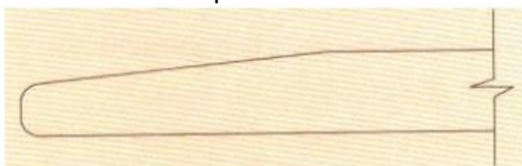
FIGURA9 – Chapa com borda rebaixada.
