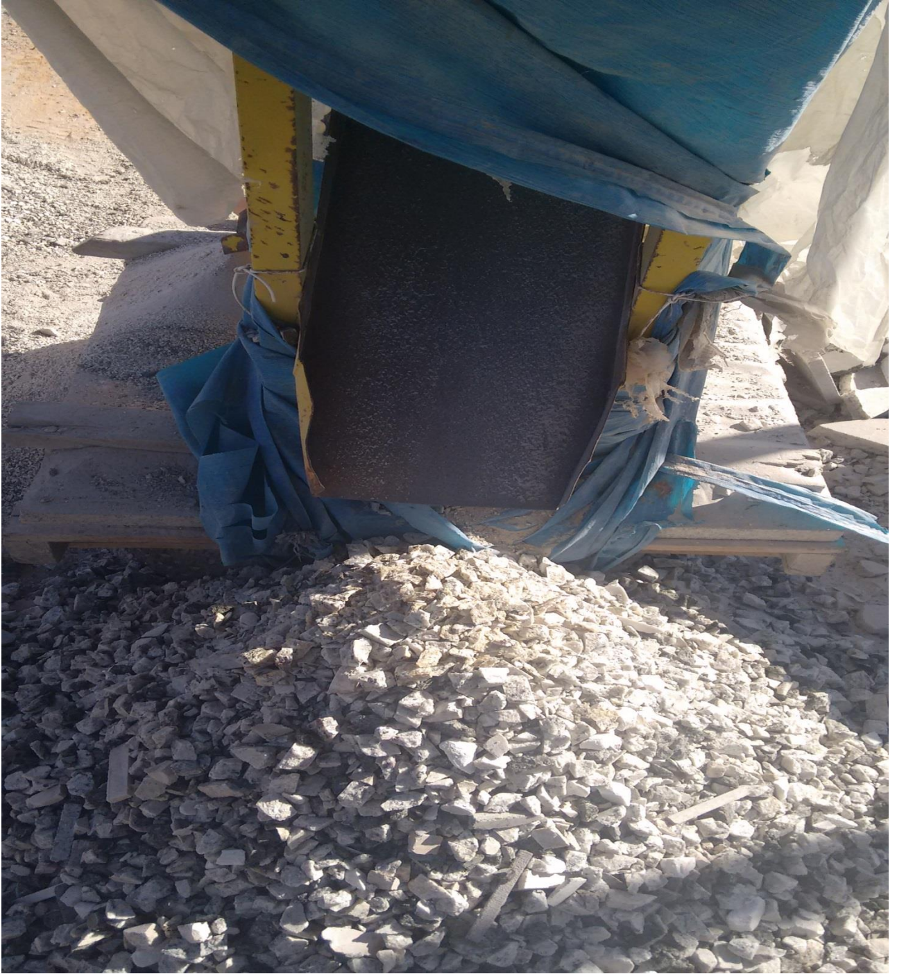
Brita feita a partir do resíduo do granito – Fonte: Autores, 2015
