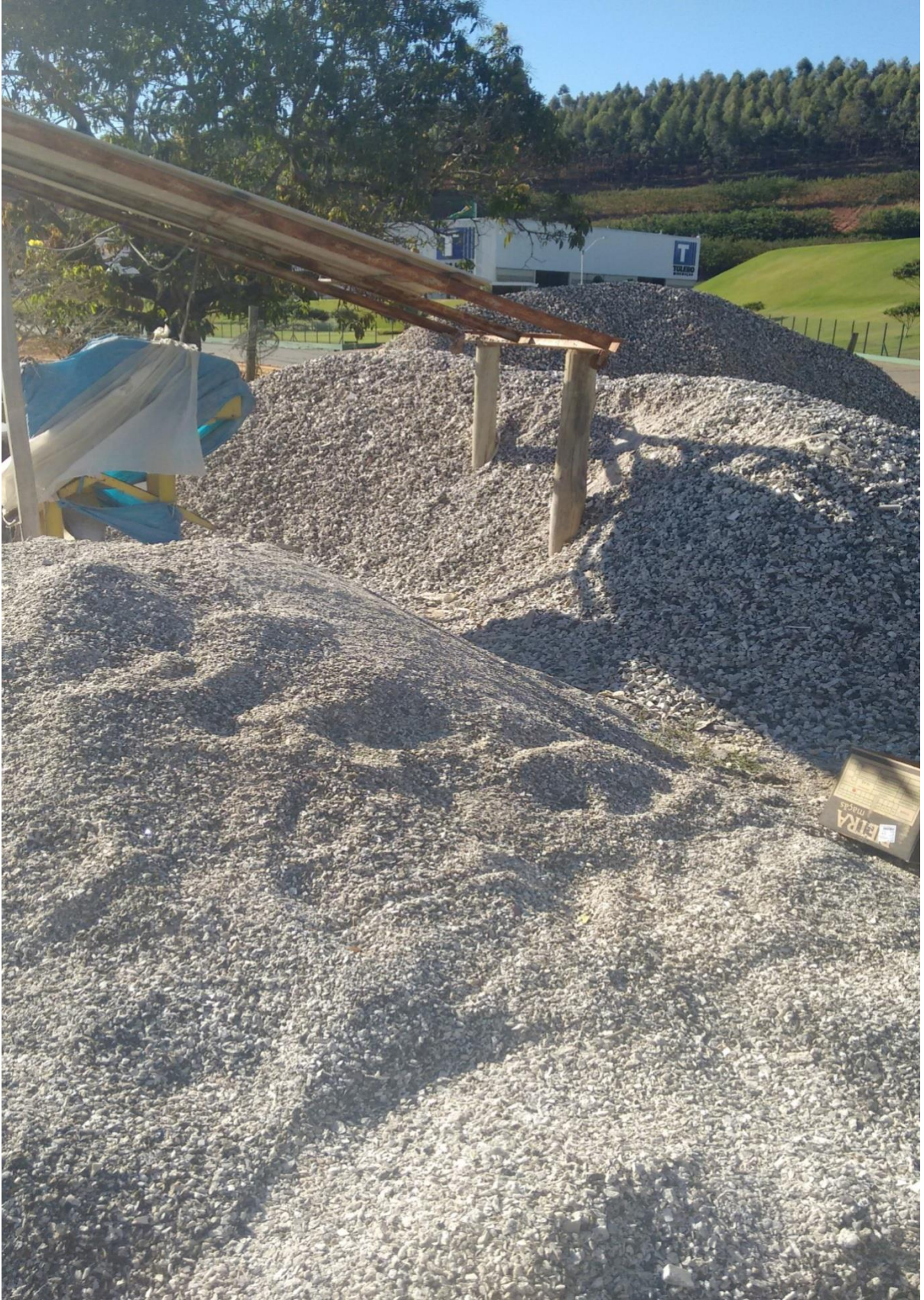
Brita feita a partir do resíduo do granito – Fonte: Autores, 2015
