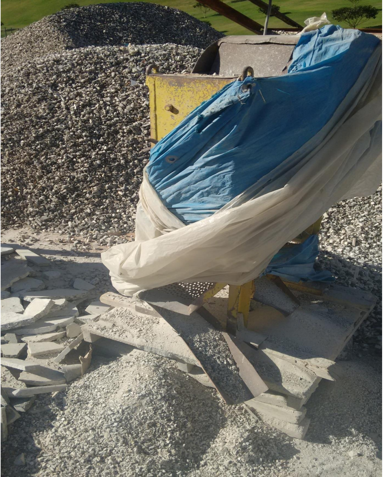
Brita feita a partir do resíduo do granito – Fonte: Autores, 2015
