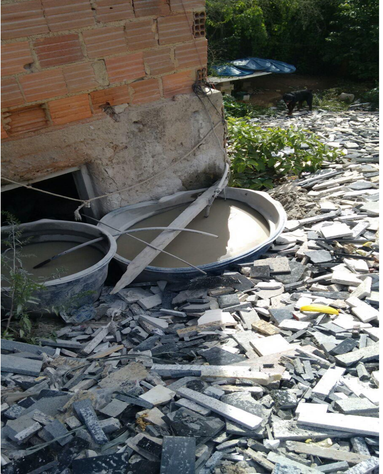
Decantação na marmoraria – Fonte: Autores, 2015
