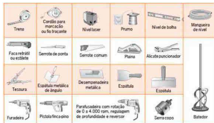
Figura 8 - Ferramentas para execução da chapa gesso acartonado
