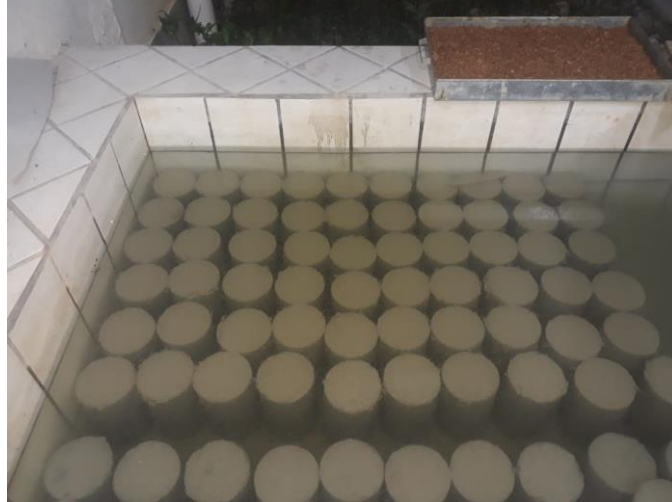
Figura 1 – Corpos-de-prova executados. Autor (2019)
