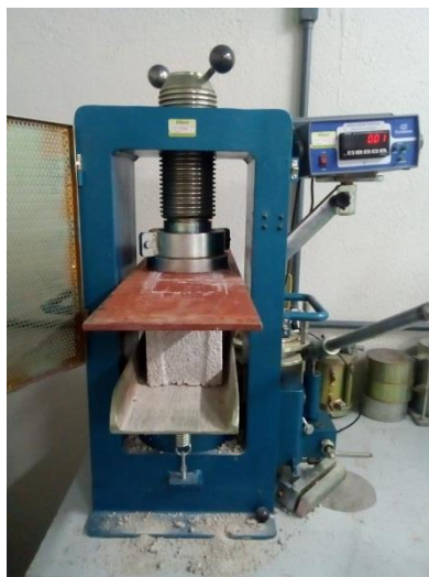
Figura 3 – Teste de Resistência à Compressão Simples (Autores, 2019).
