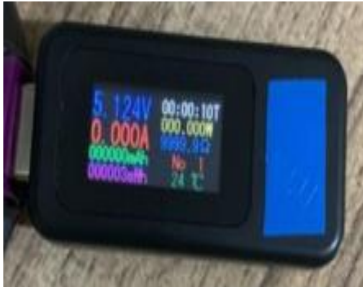
Figura 13 – Medidor de Energia
