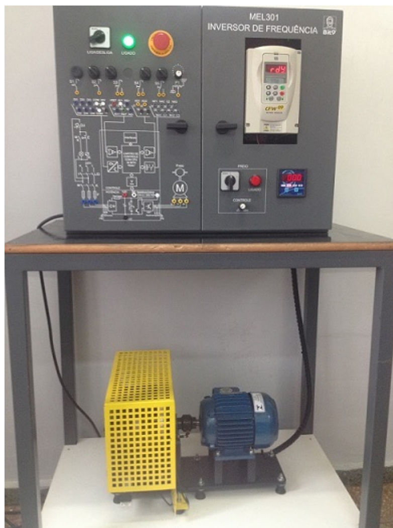
Figura 5: Bancada do Inversor CFW09, Laboratório de Máquinas Elétricas/FIC.(Fonte: AUTOR)
