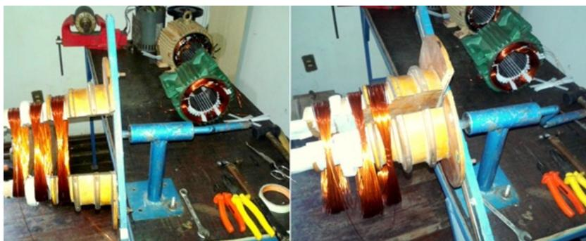
**Figura 4:** Retirada da bobina pronta na bobinadeira. Fonte: Acervo do autor
