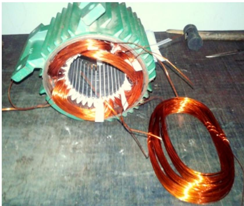
**Figura 5:** Motor 5cv Trifásico em fase de rebobinamento. Fonte:
