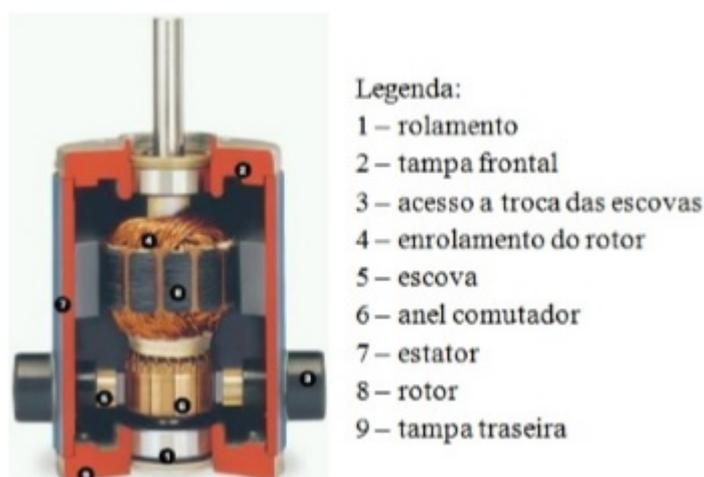
**Figura 8:** Motor de corrente contínua. Fonte: Pereira, 2010,p.35
