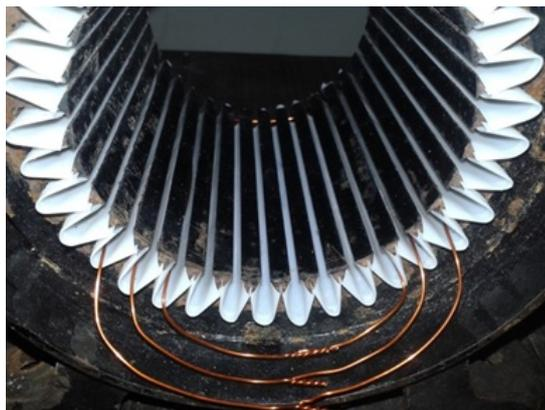
**Figura 3:** Motor empapelado com forma modelada. Fonte: Acervo do autor
