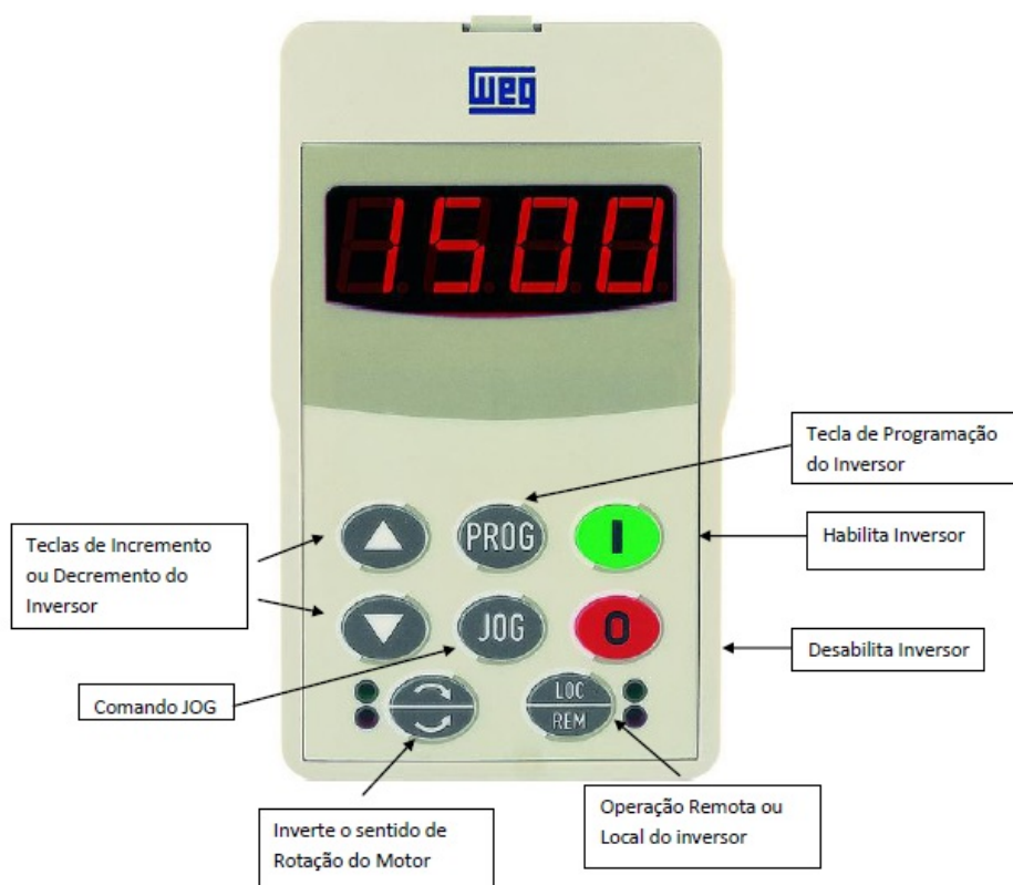
Figura 4: Interface do Inversor de Frequência Fonte: Manual do Inversor
