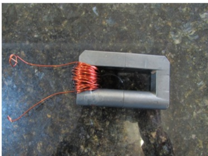
Figura 15: Transformador de corrente
