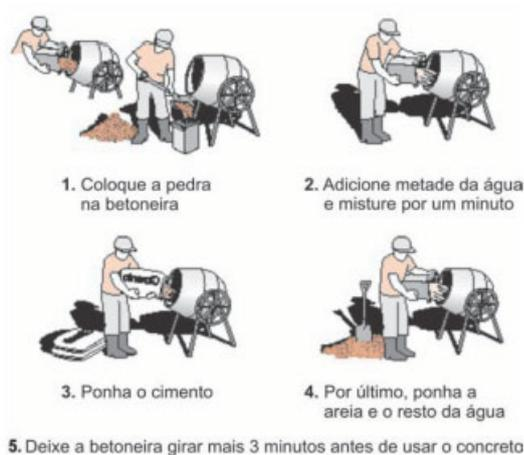
**Figura 4:** Amassamento mecânico - Fonte: ABCP, Cimento-Folheto de Orientação
