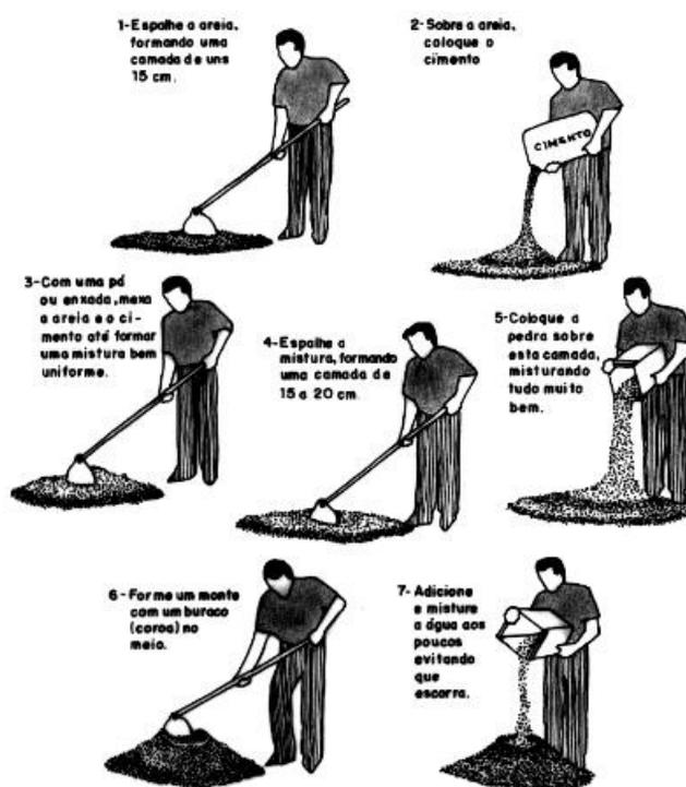
**Figura 5:** Amassamento manual - Fonte: ABCP, Cimento-Folheto de Orientação
