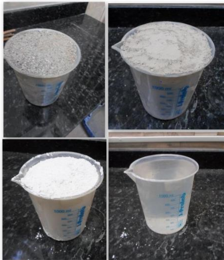
Figura 4 Dosagem de materiais constituintes para a argamassa de areia artificial– Cal – Cimento – Água
