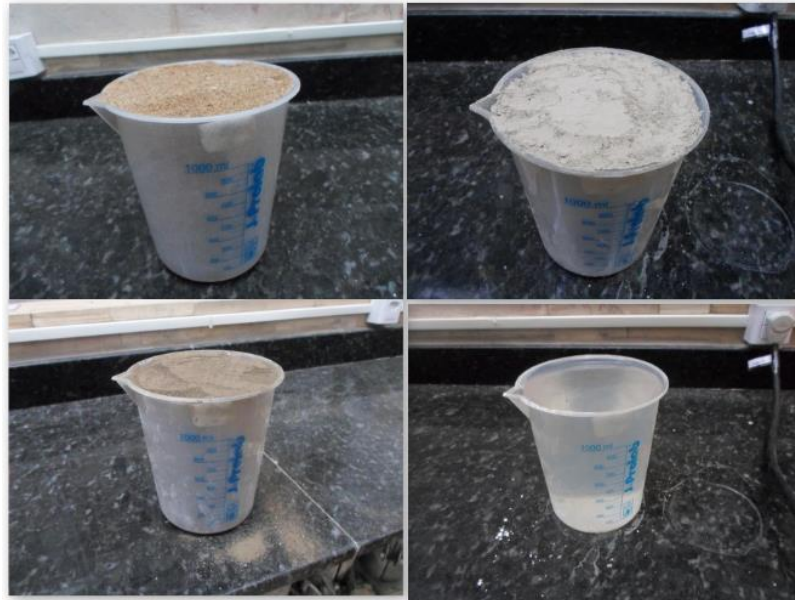
Figura 3- Dosagem de materiais constituintes para a argamassa de Areia natural – Agrofillito – Cimento – Água
