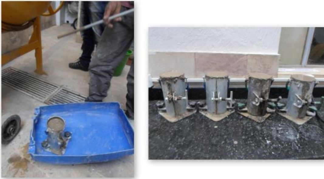
Figura 8: Confeccção dos corpos de prova
