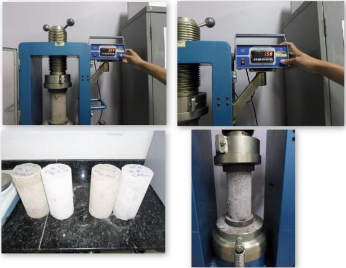
Figura 14: Rompimento dos corpos de prova 28 dias
