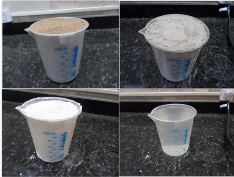
Figura 2: Dosagem de materiais constituintes para a argamassa de areia natural – Cal – Cimento – Água
