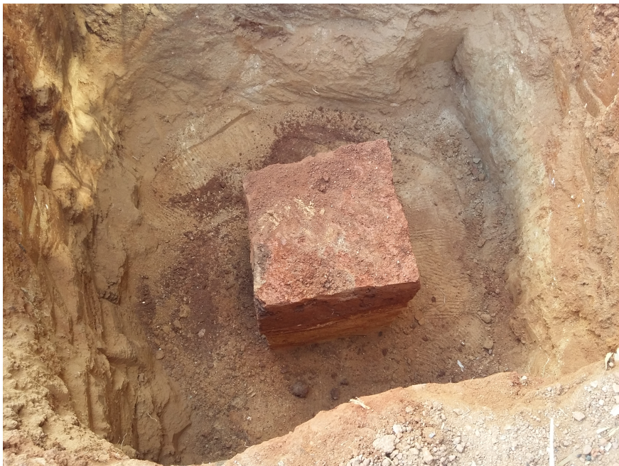
Figura 39: Moldagem do corpo de prova dentro da trincheira
