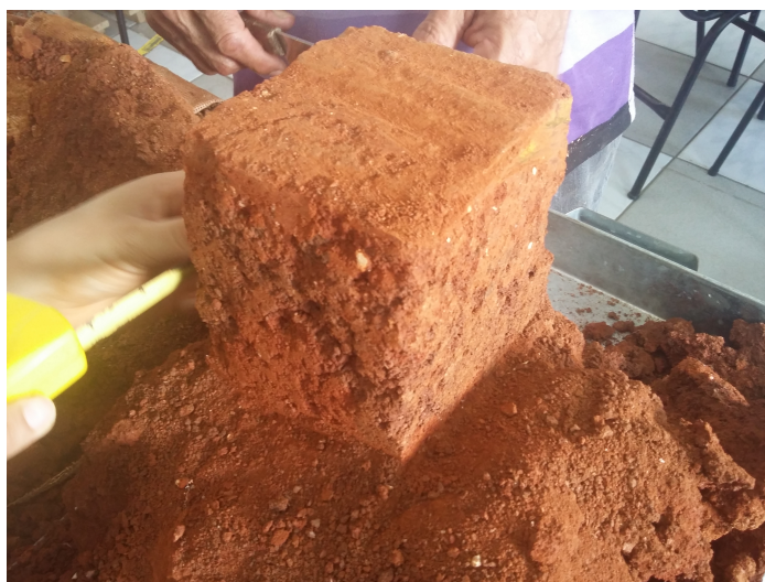
Figura 7: Cubo sendo esculpido para ensaio de determinação do peso específico
