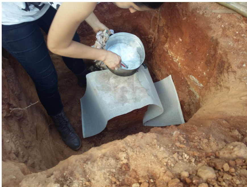
Figura 40: Aplicação da parafina sobre a talagarça
