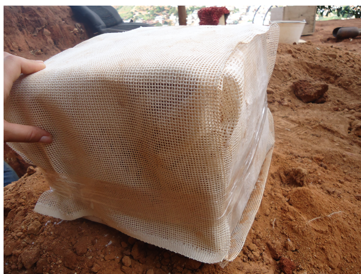
Figura 41: Retirada do corpo de prova e envolvimento do mesmo na talagarça
