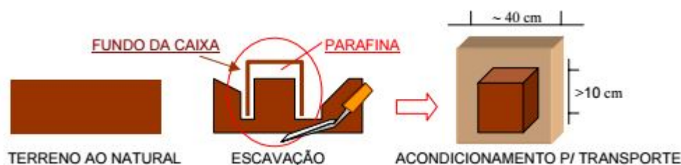
Figura 6: Processo de retirada da amostra do solo
