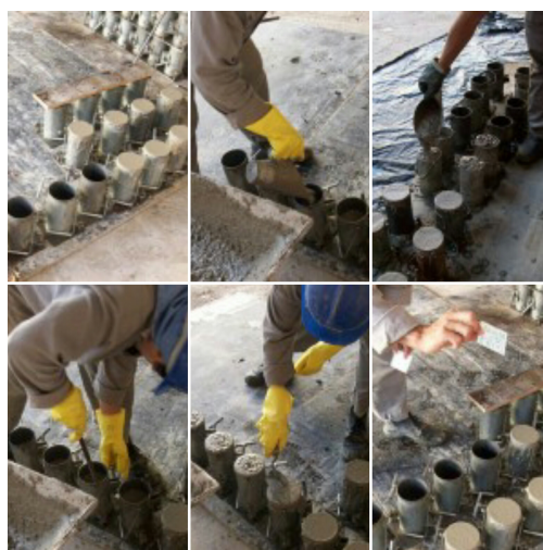
Figura 5: Moldagem de corpos de prova
