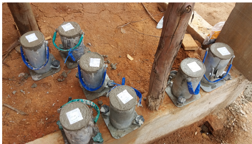
Figura 16: Corpos de prova moldados e identificados da obra estudada
