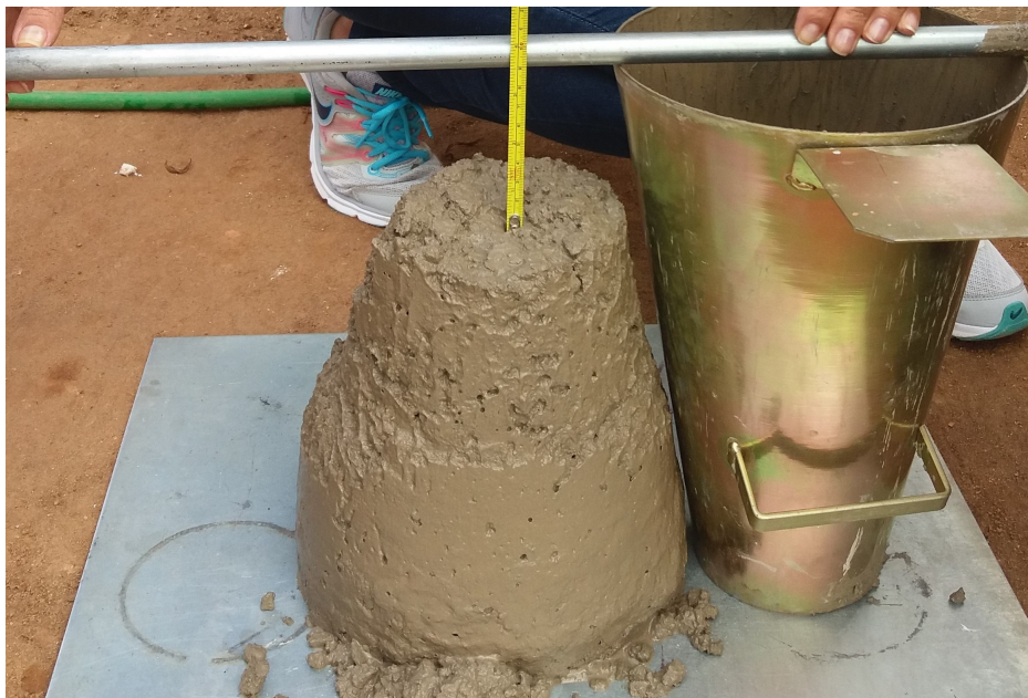
Figura 15: Ensaio de Slump Test da obra estudada FONTE: Acervo das autoras.
