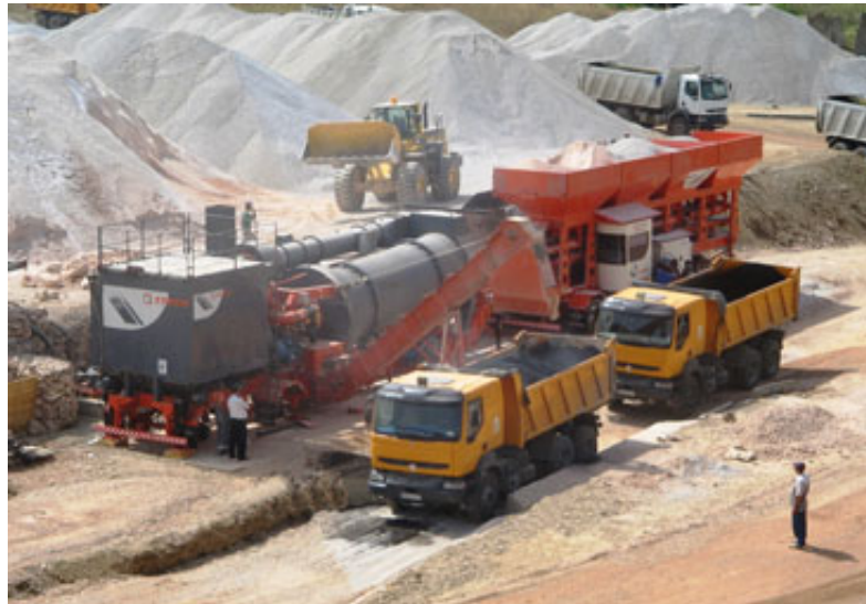
Figura 12: Exemplo de usina móvel para misturas a frio Fonte: Site CIBER (2014)
