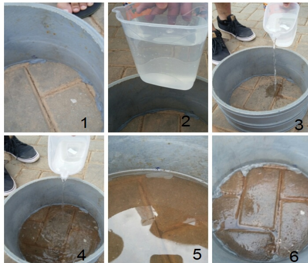
Figura 19: Etapas para o teste de infiltração. 1 Posicionamento do cilindro com a superfície inferior vedada com massa de calafetar. 2. Becker graduado para os volumes de água. 3. Início do despejo da água. 4. Enchimento do cilindro. 5. Cilindro cheio entre as marcas. 6. Finalização da prática com a infiltração total da água no pavimento.
