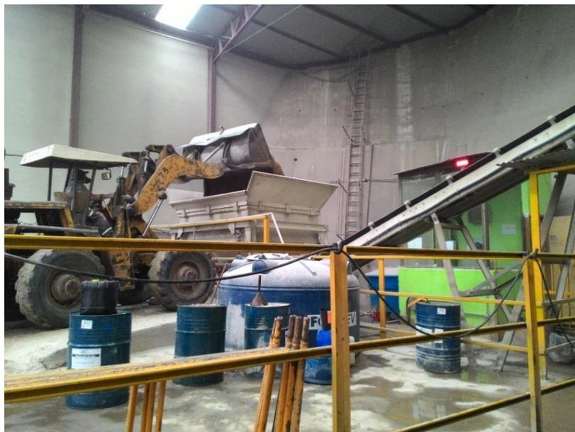
**Figura 17:** Pá carregadeira descarregando um dos agregados no silo de pesagem
