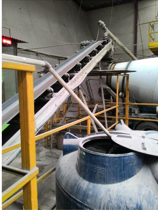
**Figura 16:** Esteira utilizada para transporte de agregados
