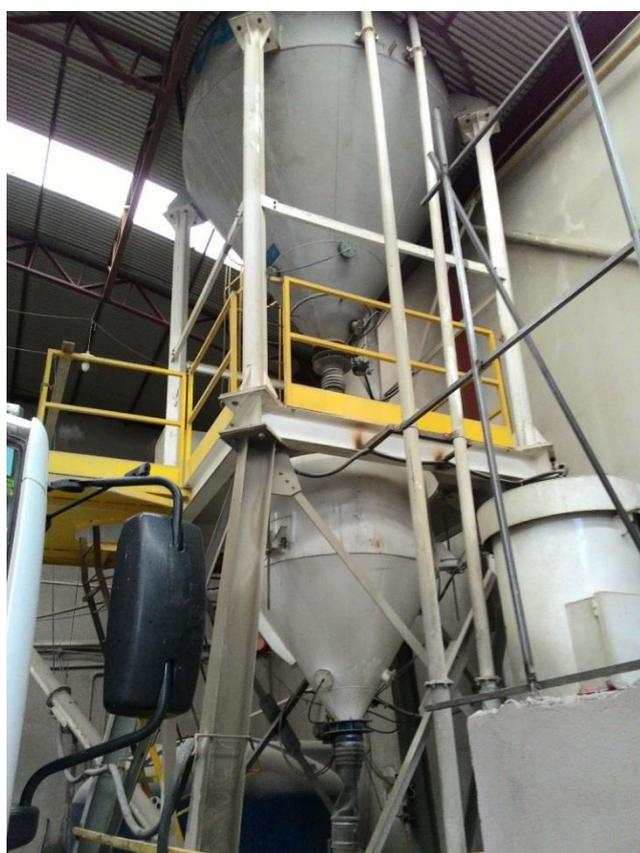
**Figura 15:** Silo com dosador utilizado para estocagem de cimento
