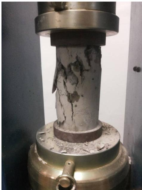
Figura 10: Testemunhos de concreto após ensaio de compressão em 7dias
