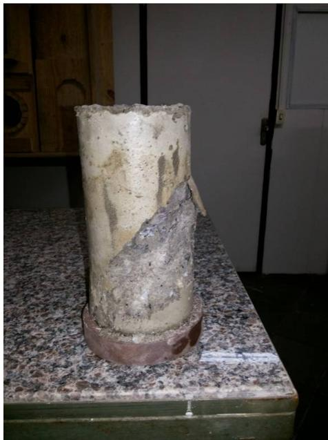
Figura 12: Testemunhos de concreto após ensaio de compressão em 28 dias
