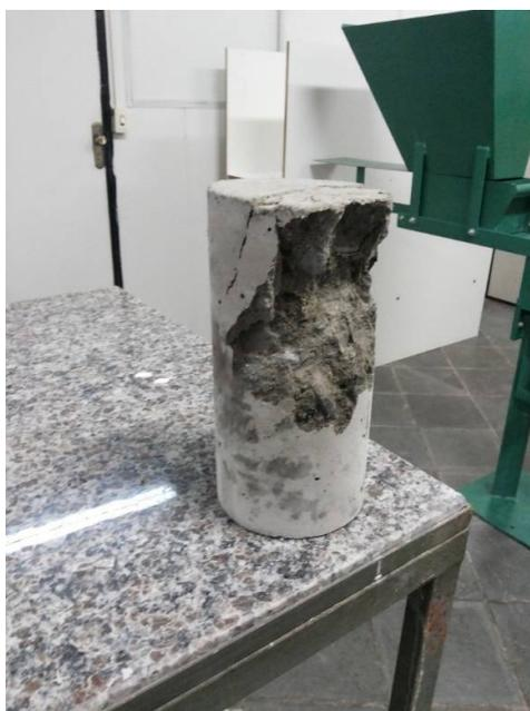
Figura 13: Testemunhos de concreto após ensaio de compressão em 7 dias
