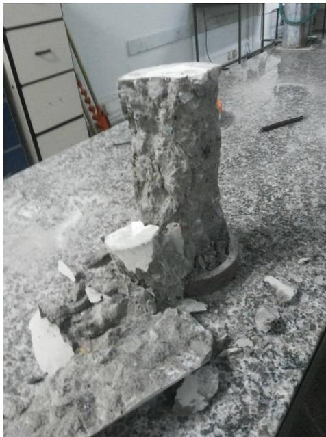
Figura 18: Testemunhos de concreto após ensaio de compressão em 28 dias
