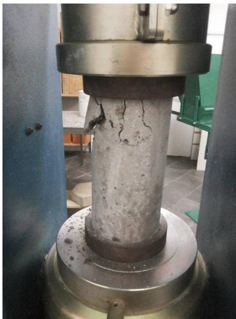
Figura 21: Testemunhos de concreto após ensaio de compressão em 28 dias
