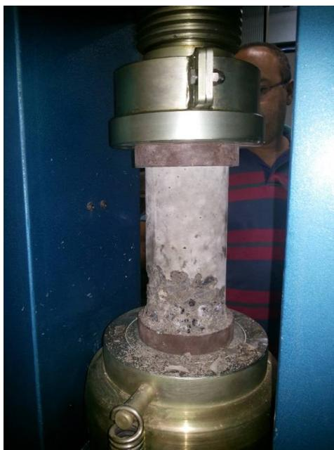
Figura 11: Testemunhos de concreto após ensaio de compressão em 14dias
