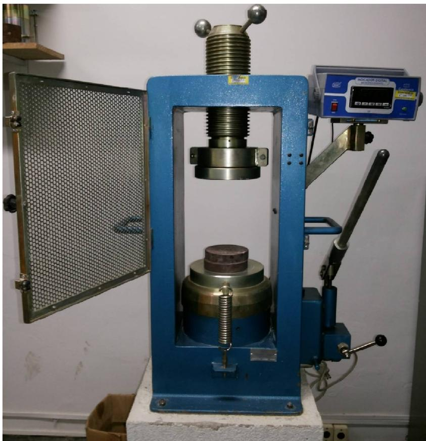
Figura 2: Prensa utilizada para a realização dos ensaios de compressão
