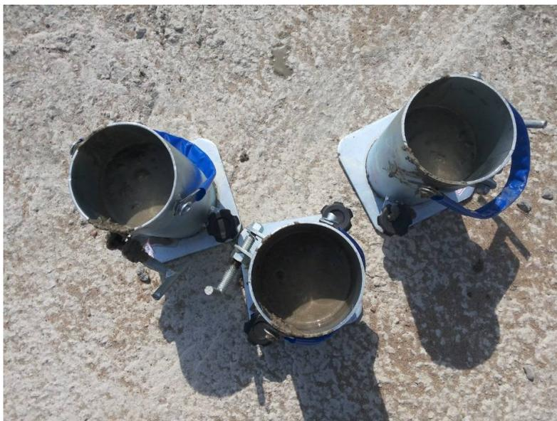
Figura 4: Foto ilustrando a colocação da primeira camada já adensada
