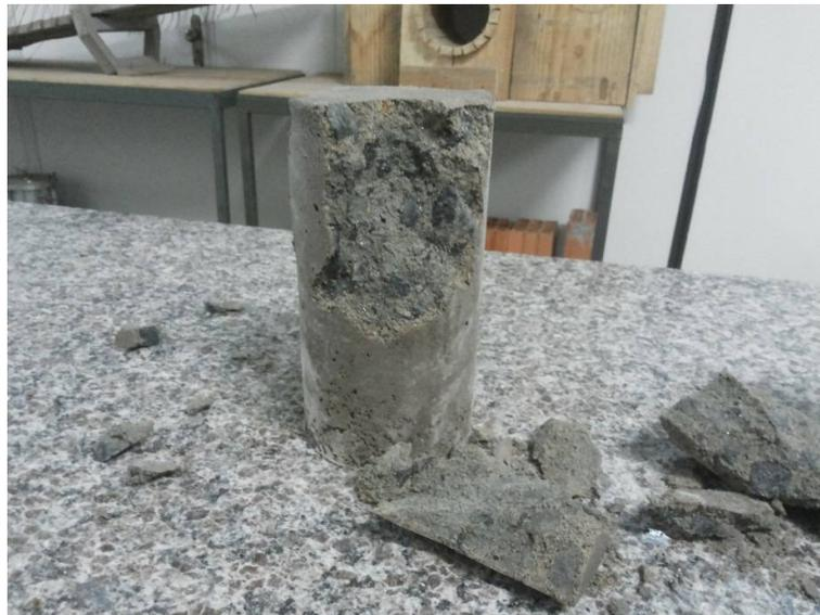
Figura 7: Testemunho de concreto após ensaio de compressão em 7 dias
