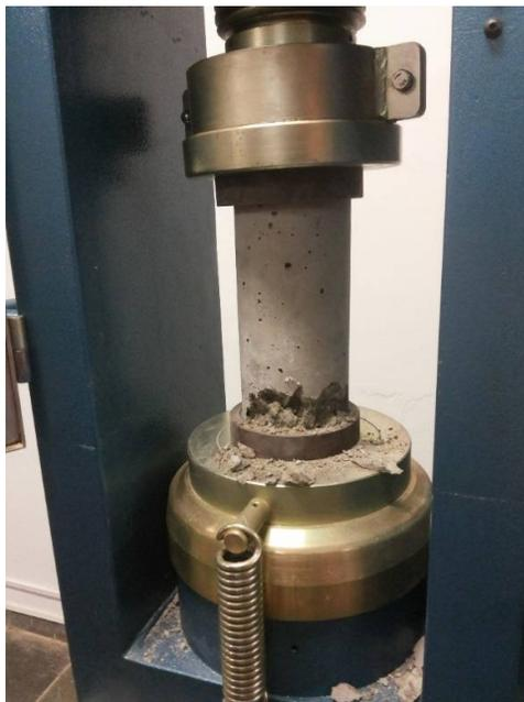
Figura 16: Testemunhos de concreto após ensaio de compressão em 7 dias
