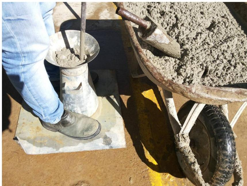
Figura 3: Ensaio de Slump teste Realizado do caminhão betoneira
