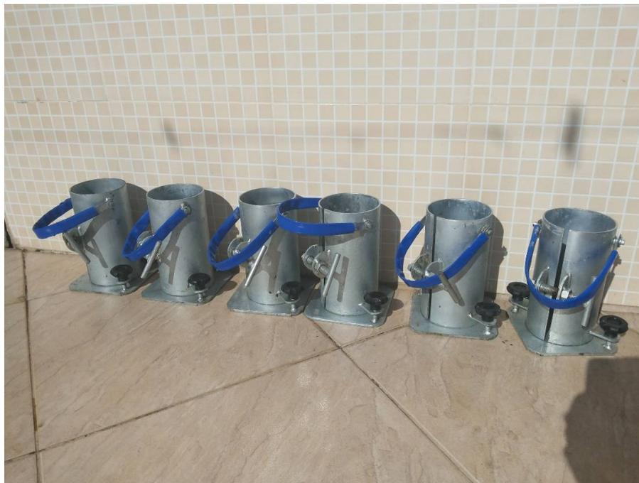
Figura 1: Moldes Cilíndricos metálico
