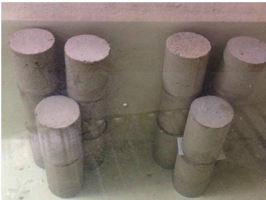
Figura 5: Corpos de prova imersos na água em câmara de cura
