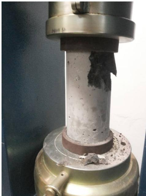
Figura 14: Testemunhos de concreto após ensaio de compressão em 14 dias
