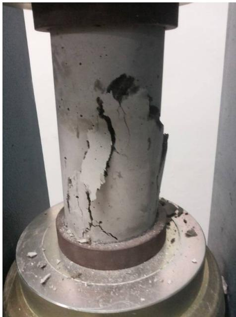
Figura 20: Testemunhos de concreto após ensaio de compressão em 14 dias
