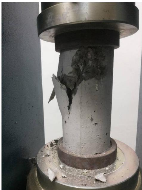
Figura 17: Testemunhos de concreto após ensaio de compressão em 14 dias
