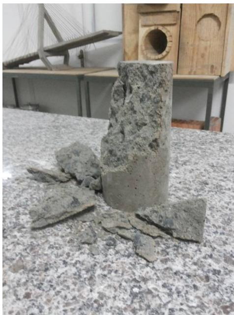
Figura 9: Testemunho de concreto após ensaio de compressão em 28 dias
