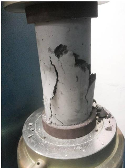
Figura 15: Testemunhos de concreto após ensaio de compressão em 28 dias
