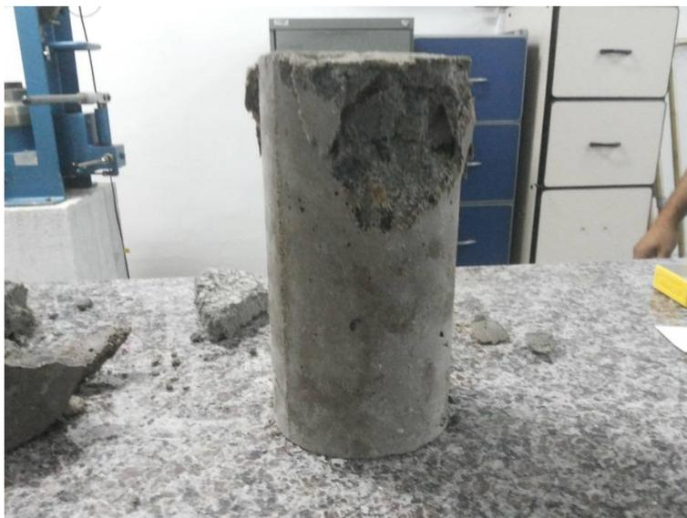
Figura 8: Testemunho de concreto após ensaio de compressão em 14 dias
