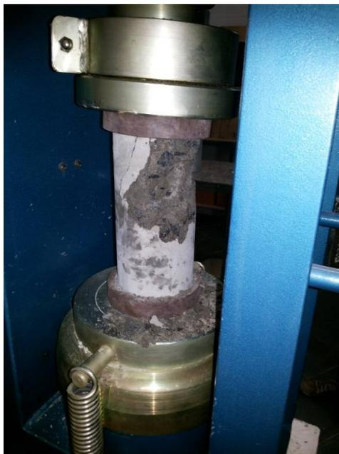
Figura 19: Testemunhos de concreto após ensaio de compressão em 7 dias
