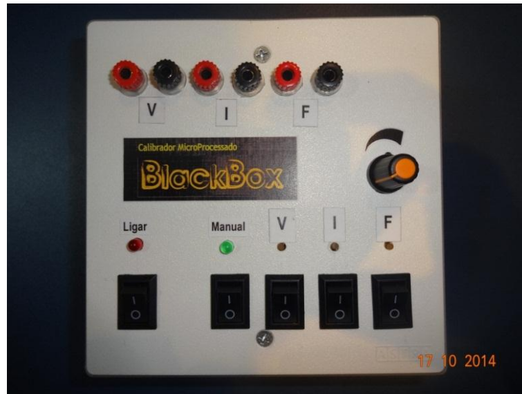
Figura 35 - Encapsulamento do BLACKINBOX
