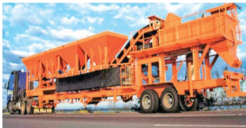
Figura 5: Exemplo de usina de pré-misturado a frio móvel 20
