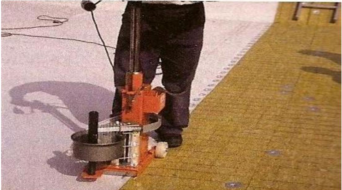
Figura 17 aparelho para fixação dos parafusos e arruelas
