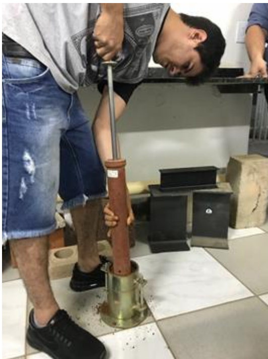
Figura4.19: Procedimento de compactação
