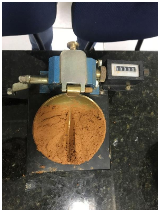
Figura 4.15: Preparação da amostra para o golpeamento
