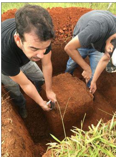
Figura3.5: Retirada da amostra indeformada e seu processo de vedação.
