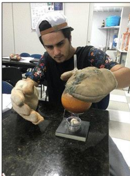
Figura 4.3: Aquecimento do picnômetro
