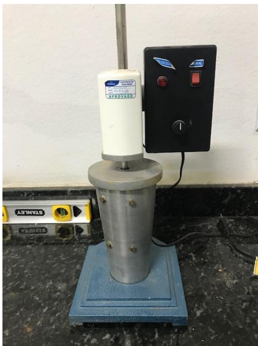
Figura4.11: Aparelho para dispersão com hélices substituíveis e copo com chicanas
