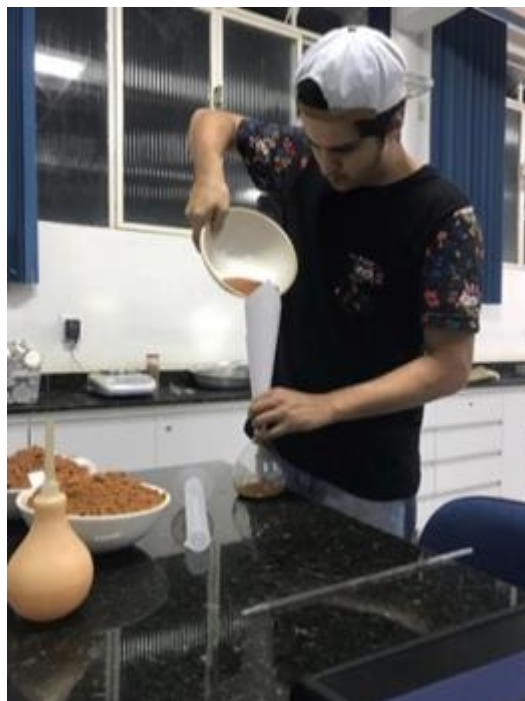
Figura 4.2: Inserção do solo no picnômetro
