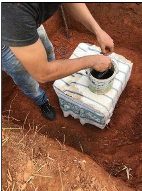
Figura3.6: Processo de vedação da amostra – demão de parafina
