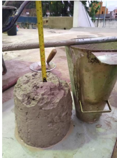
Figura 8: Ensaio de abatimento do concreto
