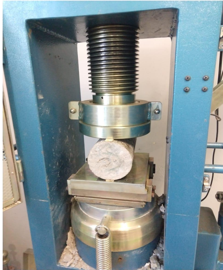
Figura 11: Ensaio de resistência à tração por compressão diametral
