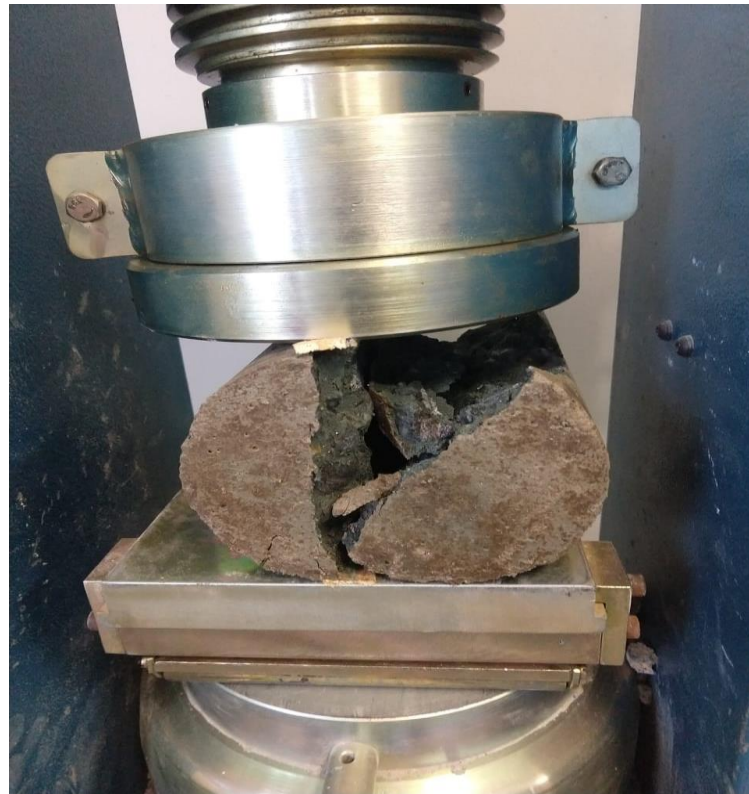
Figura 16: Ensaio de resistência à tração por compressão diametral
