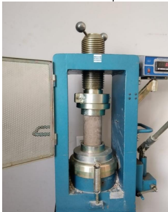
Figura 10: Ensaio de resistência a compressão do concreto
