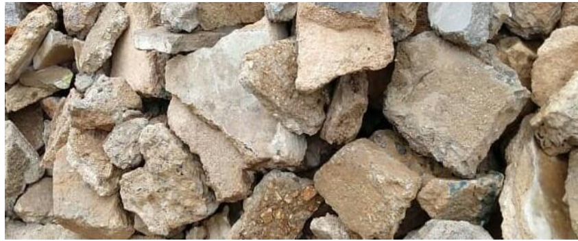
Figura 2: Resíduos de demolição de edificações
