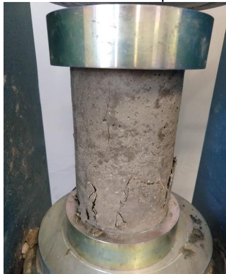
Figura 15: Ensaio de compressão axial
