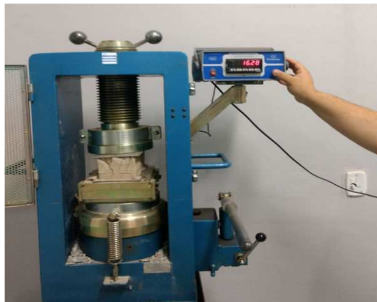
Figura 11: Execução do ensaio de resistência à compressão.
