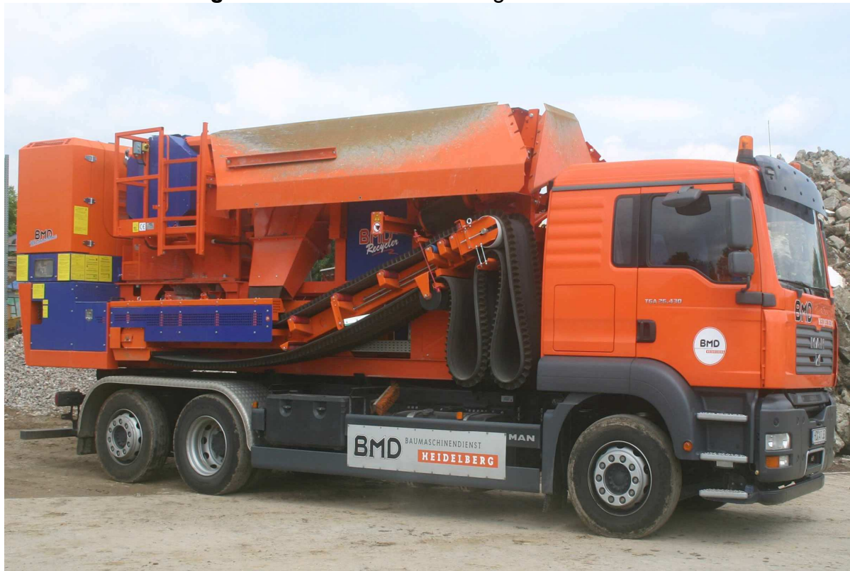
Figura 4: Usina móvel de britagem de entulhos
