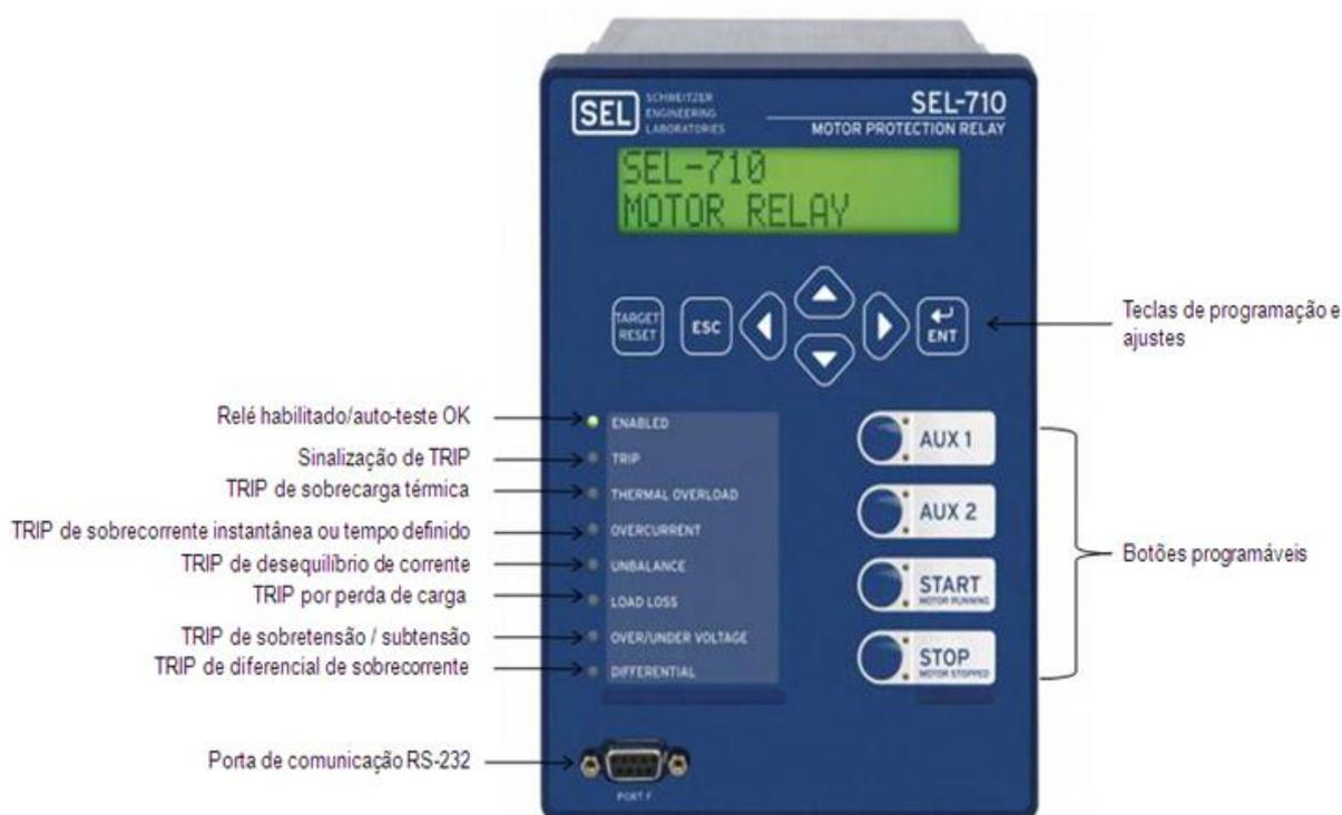
Fonte: Manual SEL-710 Motor Protection Relay (2017)
