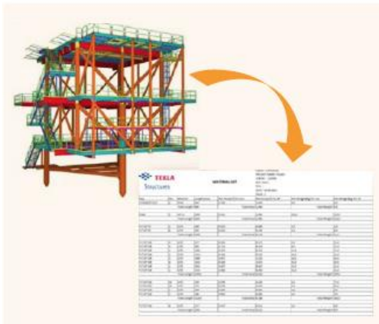
Figura 4 - Exemplo de extração de quantitativos de componentes de um modelo BIM.
